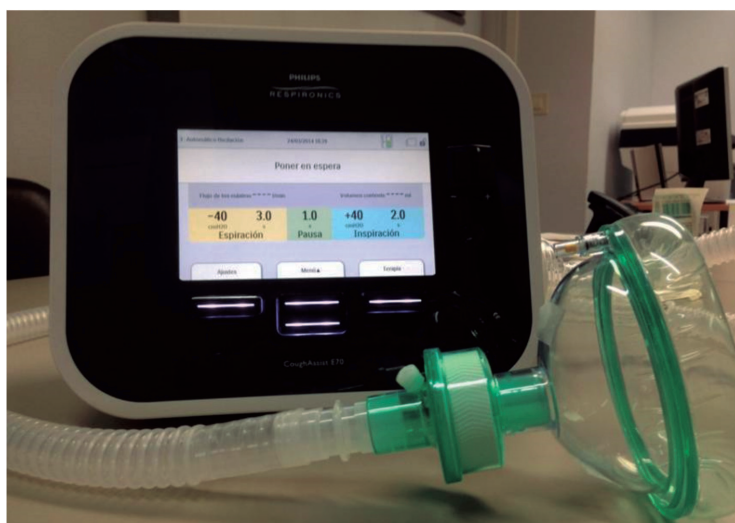
Figura 20. Asistente de tos con filtro antimicrobiano y máscara para uso no invasivo (Philips E70).
